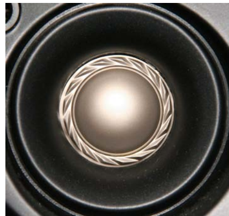
3.2.1 Kalottenlautsprecher einer HiFi-Box
